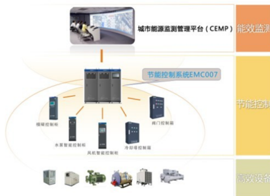
图 4-1 中央空调节能控制系统架构图
