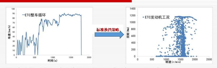
不同变速箱、速比、变化换挡控制策略对发动机工况的影响
