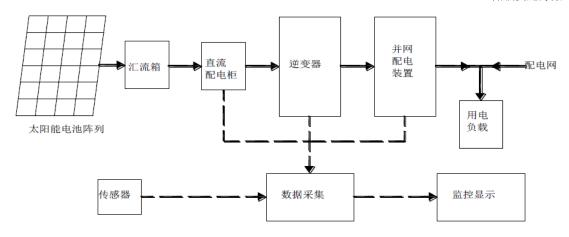
附图 2-1 光伏并网系统原理示意图
