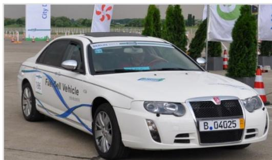
取得重要进展。轿车动力系统技术平台采用燃料电池-动力电池混合驱动的构型方案，形成了千套级燃料电池轿车动力系统平台的集成能力。燃料电池客车形成的燃料电池-动力电池动力系统技术平台，攻克了制动能量回收、蓄电池系统热电管理技术、双燃料电池堆独立运
