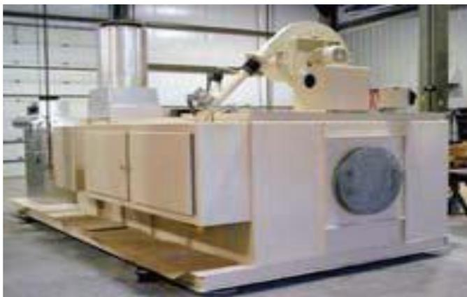
图9 催化氧化系统 (CO, Catalytic Oxidizer) <sup>28</sup>
