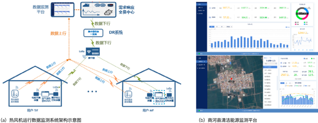
图 19 商河县热泵热风机运行大数据监测平台
