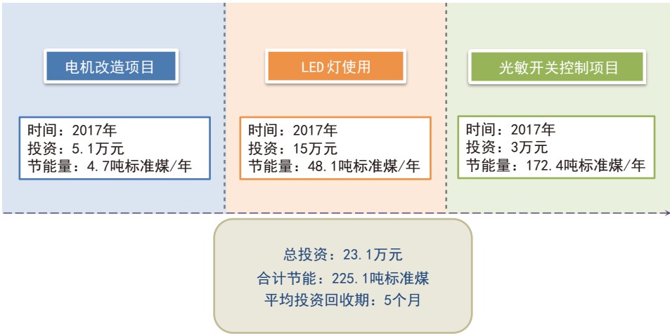
图 61 2017 年爱森（中国）絮凝剂有限公司实施的节能改造项目
