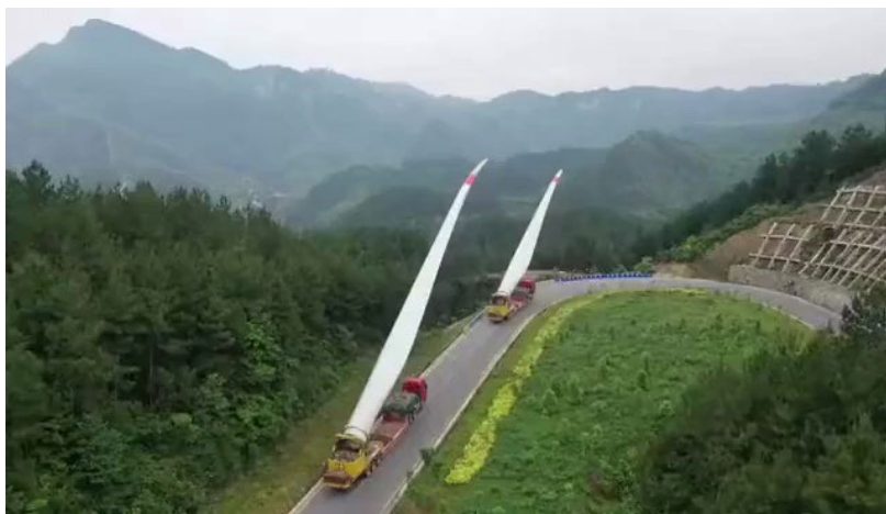
图 3-9 低风速山地风电场叶片专用运输车
