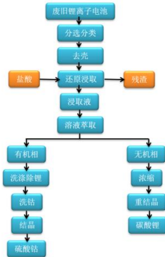
图 1-6 锂动力电池湿法回收工艺
