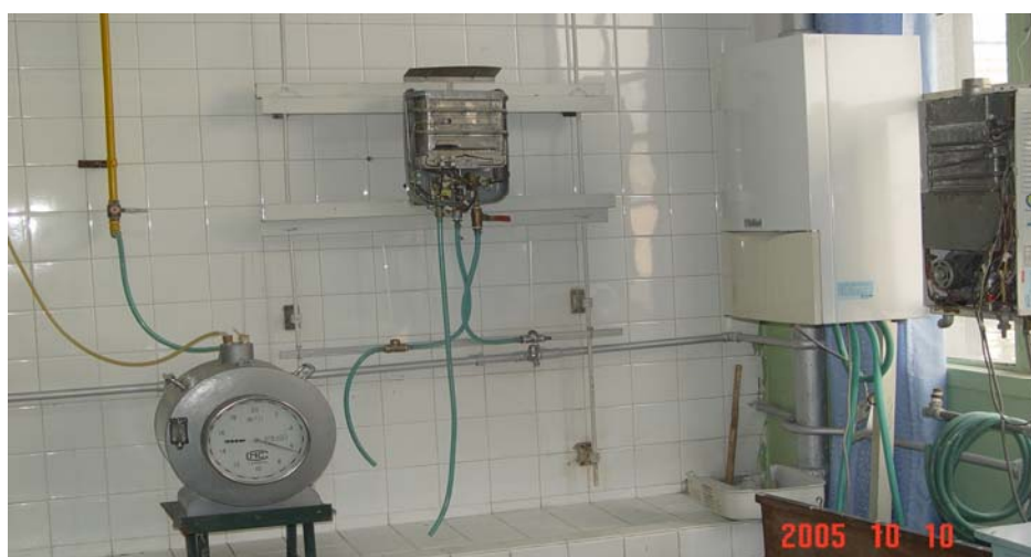
图 3-3 北京建筑工程学院暖燃实验室热水器性能试验检测台 2
