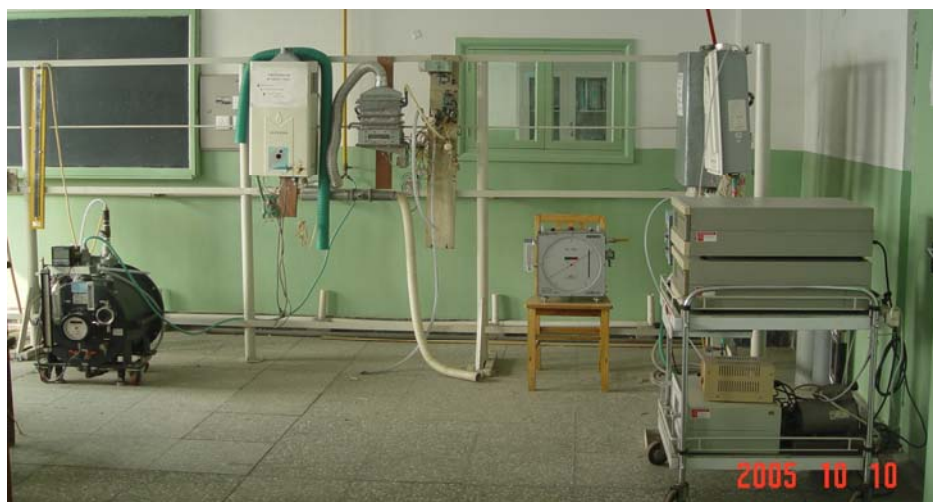
图 3-1 国家燃气用具质量监督检验中心（天津）热水器检测台
