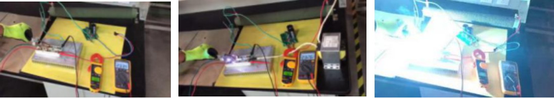
(a) 无电弧现象 (b) 操作时的火花放电 (c) 操作时燃弧
