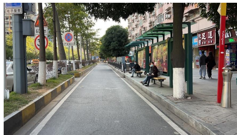
怡港花园站，公交乘客需穿越非机动车道上车
