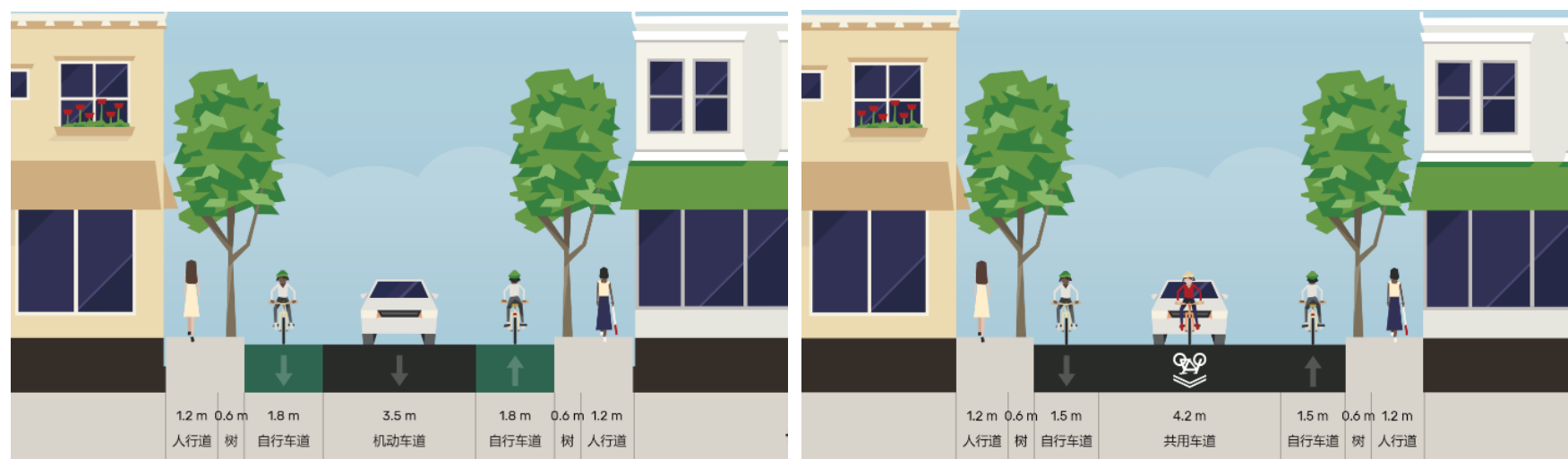
广州市商业型支路-荔湾区宝华路(上-现状照片，下左-现状断面，下右-改善断面)
