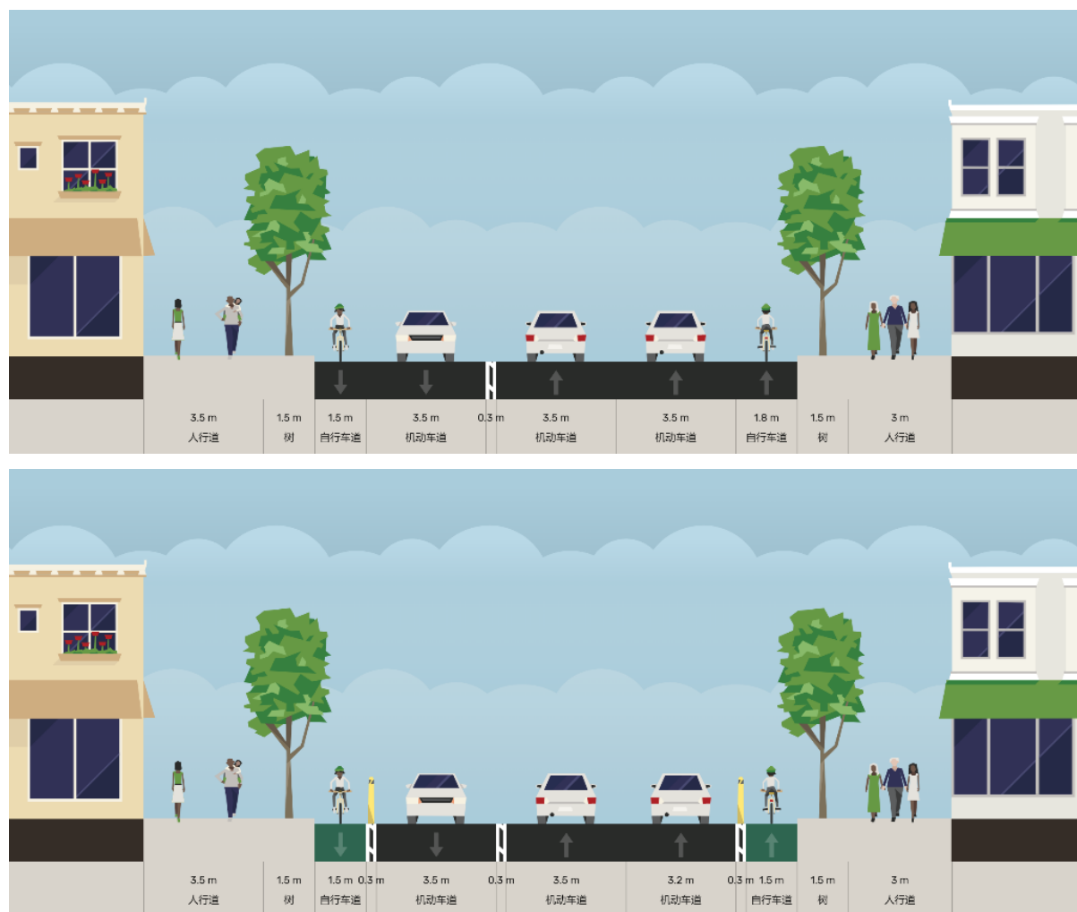
广州市交通型支路-越秀区吉祥路(上-现状照片，中-现状断面，下-改善断面)
