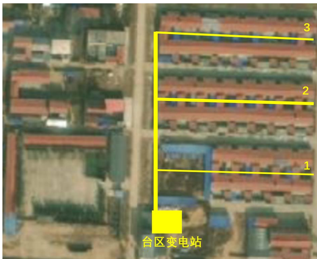
图 7 台区电缆位置
