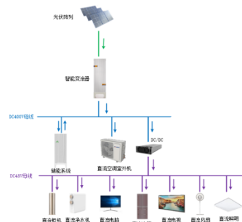
图 19 光伏驿站系统架构
