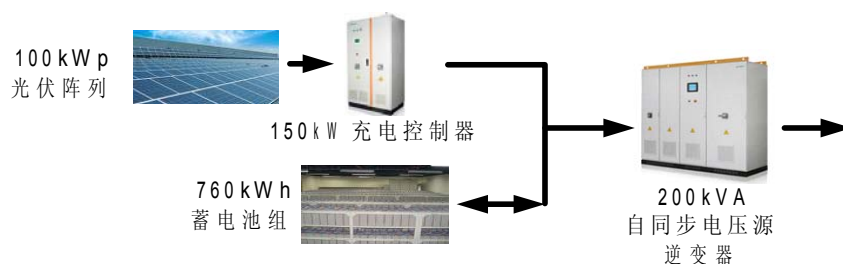
(c) 自同步电压源光伏发电单元
