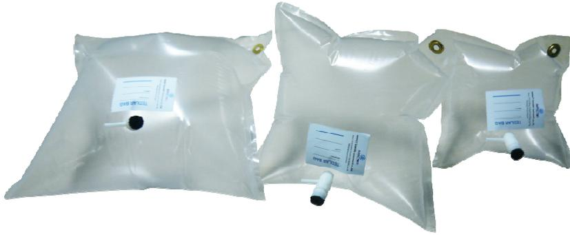
图 2-4 收集机动车尾气所使用的采样袋
