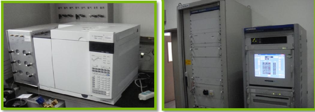
图 2-13 CH<sub>4</sub> 检测气相色谱&HORIBA 测量设备图
