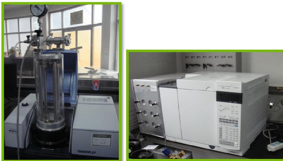
图 2-17 布鲁克 TENSOR27 红外光谱和配备 FID&ECD 检测器的安捷伦 7890A 气相色谱
