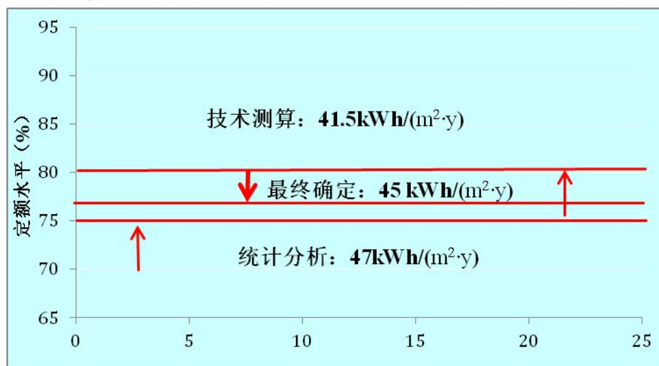
图 6.11 统计与技术结合确定引导性指标值示意图
