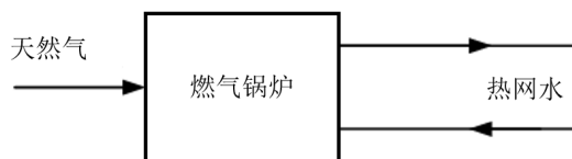
图 7 燃气锅炉供热示意图
