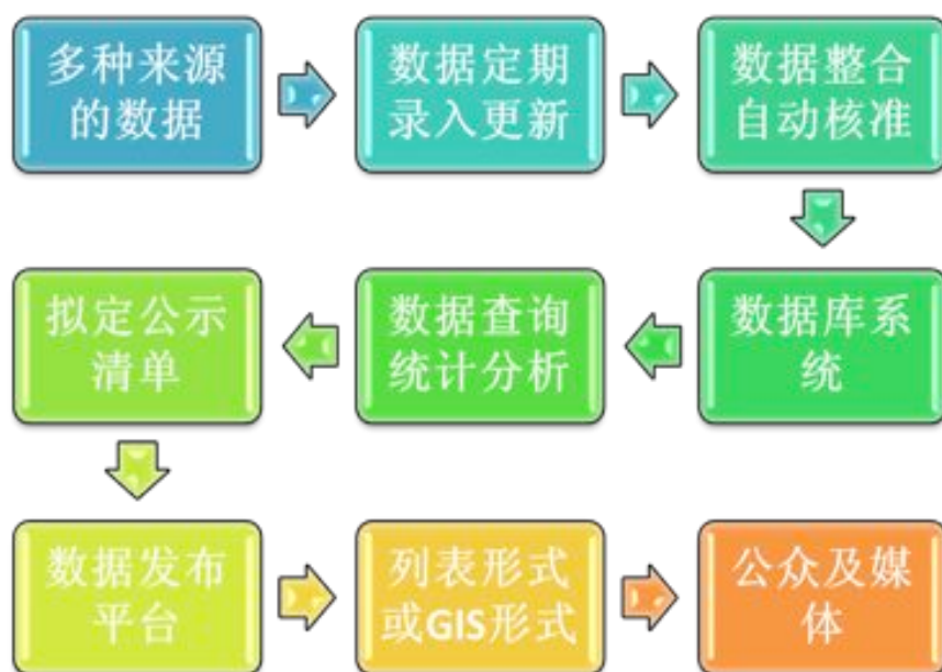
图 6.1 数据库系统及发布平台的总体结构
