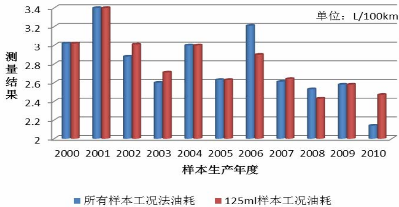
图 2-30 各生产年度排量 125 mL 样本工况法油耗测量结果
